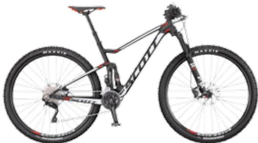
Rahmenrohre aus hydrogeformtem, konifiziertem 6011-SL-Alu. FOX Federung, Shimano Antrieb.
