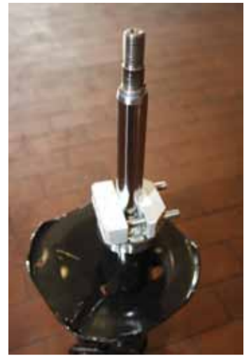
Klemmbacke mit Klemmschrauben (abhängig vom Ø der Kolbenstange) bestücken Klemmbacke platzieren
