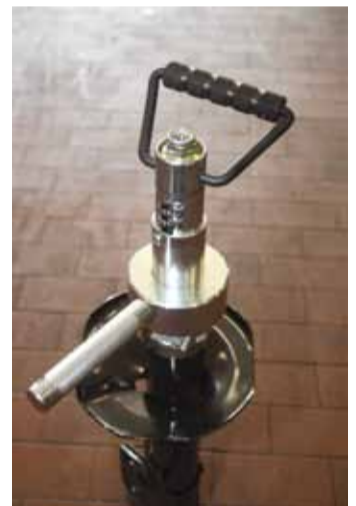
Kolbenstange mit Original-Befestigungsmutter fixieren
