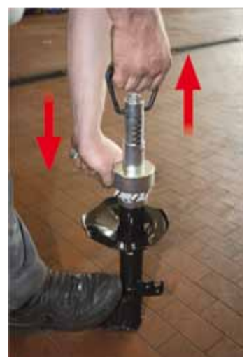
Teleskoprohr kräftig mit Handkraft herausziehen und durch leichte Links- bzw. Rechtverdrehung verriegeln
