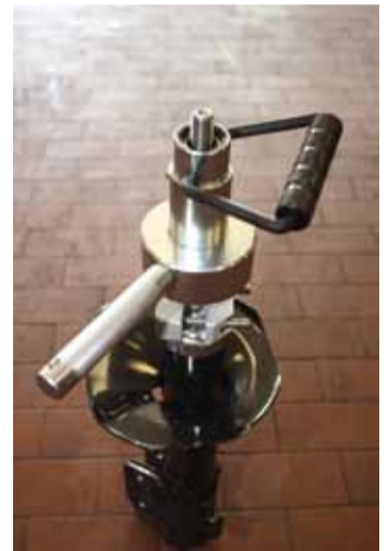
Teleskop-Grundgerät in Zwischenlageraufnahme einschrauben und Einheit am Stoßdämpfer platzieren
